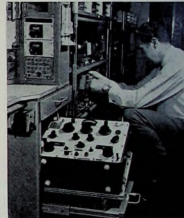
In der ausgezogenen Schublade befindet sich der Cassor-Meßsender „CRM 555“, der während des Fluges für Tests die beim ILS- oder VOR-Anflug empfangenen Signale erzeugt
