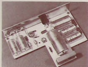
Bild 11 Elektronisch stabilisiertes Netzteil: a) Einzelteilanordnung, b) fertiger Baustein
