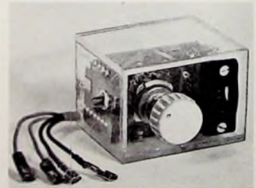
Bild 3. Vorderansicht der erweiterten Intervallsteuerung im Plexiglasgehäuse
