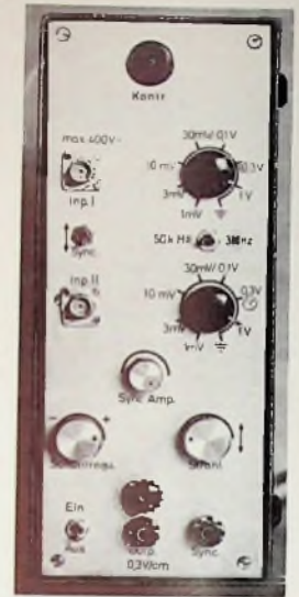
Bild 3. Frontplatte des Zweifachschalters
