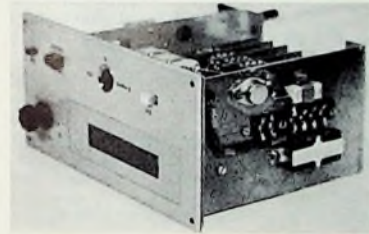
Bild 14. Innenbau mit Blick auf die Unterseite und auf die Kühlplatte der Stromversorgung mit Leistungstransistor, Gleichrichter und 3-Ohm-Widerstand; in dieser Art (ohne Gehäuse) ist der Zähler auch für Gestellbau geeignet ◀
