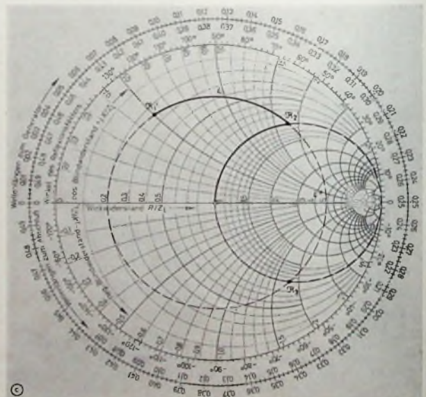
Bild 17. Transformation des Widerstands R_1 in den Wellenwiderstand Z durch ein Leitungstück der Länge L und einen induktiven beziehungsweise kapazitiven Reihenwiderstand. a) Transformationsprinzip bei kapazitivem, b) induktivem Reihenwiderstand, c) Diagrammeinträgung
