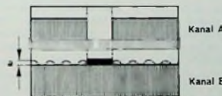
Bild 10. Einstellen des HF-Modulators auf 3 MHz; die Schwebungsnulstelle liegt dann in den Weißwerten
