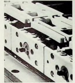
Testfassungen zur Aufnahme der Transistoren beim Durchlauf durch die „Super-Cat“
