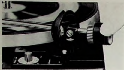
Bild 5. Tonarmlagerung mit Gegengewicht; links unten Einstellknopf für die Antiskatingkraft
