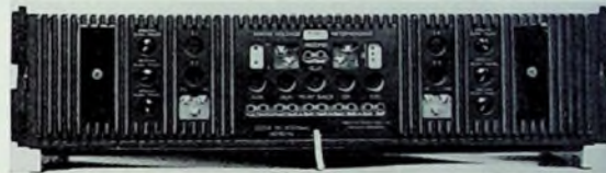
Bild 2. Rückseite des „Arena T 9000“ Die gesamte Rückwand ist mit Kühlrippen versehen und dient als Kühlfläche für den 2x75-W-Verstärker. Man erkennt, daß sowohl die europäischen als auch die amerikanischen Anschlüsse vorhanden sind.
