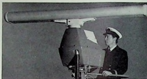
Hohlleiter-Abtastantenne der neuen Radaranlage „RM 916“ (11,8 m lang) mit Antennengetriebe. In der hier gezeigten Ausführung ist das Sende-Empfangsgerät mit Wechselrichter unterhalb der Antenne eingebaut. Zusammen mit dem an beliebiger Stelle untergebrachten Sichtgerät besteht die Gesamtanlage dann aus zwei Einheiten.
