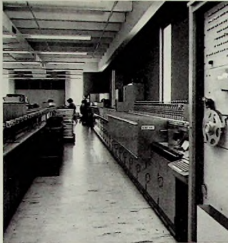
Automatische Prüfmaschinen („Super-Cat“) für „Sillect“-Transistoren
