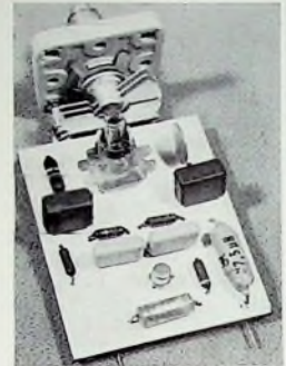
Bild 2. Anordnung der Bauteile auf der Resopalplatte
