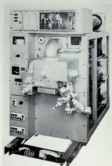
Bild 5. Zweistufiger Tonsender-Leistungsverstärker mit 30 dB Verstärkung für 1 kW Ausgangsleistung einschließlich Stromversorgung für Endstufe und Vorstufe und Schallanlage
