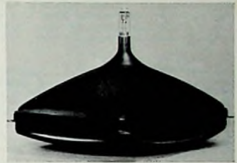
Bild 1. Ansicht der neuen 110°-Farbbildröhre A 66-140 X
