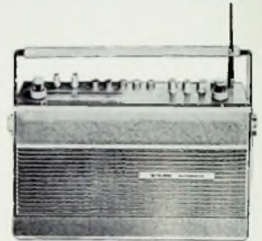
Koffersuper „Stern Automatik“ mit drei UKW-Stationstasten
