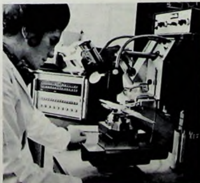
Bild 7. Rechnergesteuerte Vorrichtung zum Ultraschall-Kontaktieren von IS
