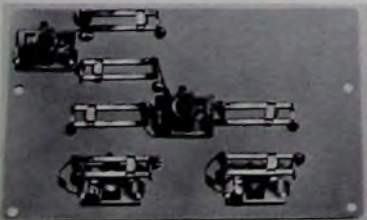
Filteranordnung einer Antennenweiche „Awa 643 m K... + K... + K...“ (Hirschmann)
