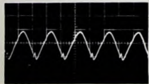
Bild 12. Wechselspannung am ersten Ladekondensator der Kaskade; 50 V/Skt., 10 ms/Skt.
