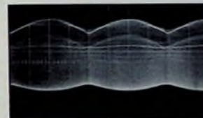
Bild 16. Spannung am Punkt x_1 des Ablenktromtransformators; 20 V/Skt., 5 ms/Skt.
