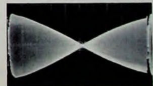
Bild 6. Hüllkurve der Nord-Süd-Korrekturspannung; 100 V/Skt., 2 ms/Skt.
