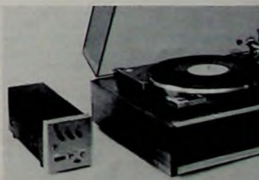
Bild 4. Vier-Kanal-Wiedergabeeinheit (links) als Ergänzung eines normalen Stereo-Plattenspielers
