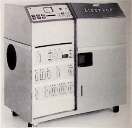
Bild 5 Rückansicht des Gretag „5070“: Links: Bedienpult und Elektronik; rechts: optisch-mechanischer Teil
