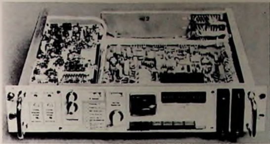
Bild 6. Printplatte für NF-Modulationsvergleich, Träger- und Reflexions- überwachung
