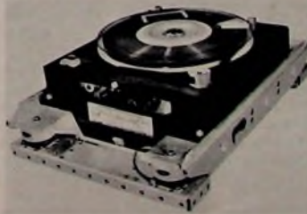
Bild 4. Magnetband-Aufzeichnungsgerät der SFIM, geöffnelt
