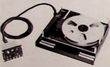
Bild 5 Ampex brachte verschiedene Datenregistrierensysteme heraus, die sich nicht nur für die Aufzeichnungen der Flugzeug-Borddaten eignen. „AR-1700“ (oben) kann mit Bandgeschwindigkeiten von 3,75 bis 120 Zoll je Sekunde arbeiten; das „AR-700“ (unten) wurde besonders für Einsätze entwickelt, bei denen größter Wert auf geringes Gewicht und geringes Volumen gelegt wird
