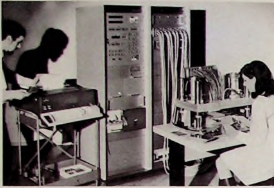
Links: Rechnergesteuerter Verdrahtungsprüfautomat „VD 20“ mit Protokoll-Blattschreiber, Zentraleinheit, Matrixschrank und Anpassungseinheit zum selbsttätigen Prüfen von geätzten Leiterplatten. Rechts: Prüfadapter für mehrlagige Leiterplatten
