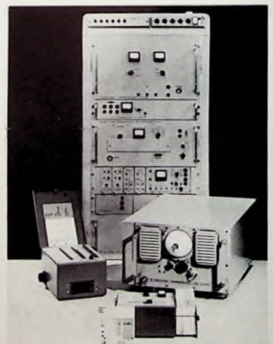
1-kW-Kurzwellen-Universalsender „SK 1/39“ von Rohde & Schwarz (Hintergrund) mit Abstimmereinheit (Programmiergerät Mitte links, Antennenanpaßgerät Mitte rechts) sowie Programmierzusatz „GB 001“ (vorn), dessen Programmkarte alle Einstellbefehle für die Sendeanlage enthält
