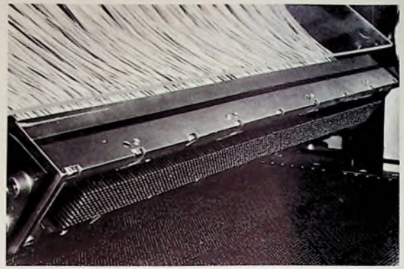
Links: Rechnergesteuerter Verdrahtungsprüfautomat „VD 20“ mit Protokoll-Blattschreiber, Zentraleinheit, Matrixschrank und Anpassungseinheit zum selbsttätigen Prüfen von geätzten Leiterplatten. Rechts: Prüfadapter für mehrlagige Leiterplatten
