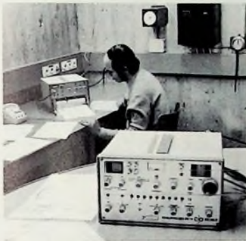
Bild 8. Meßraum im Empfängerturm; im Vordergrund der Empfänger auf dem Drehtisch, hinten links der Schreiber zum automatischen Aufzeichnen der Richtdiagramme
