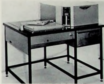
Bild 1. Bestückungstisch „HBS 32/64“ von Spirig. Die linke Seite enthält die Projektionseinrichtung und die Arbeitsfläche mit dem Spann-/Schwenkrahmen zur Aufnahme der Leiterplatten; auf der rechten Seite befindet sich das Magazin mit 32 Bauelementeschalen, die synchron mit dem Bestückungsvorgang — zum Zugriff bereit — jeweils in die abgeschrägte Ecke des Magazins vorrücken.
