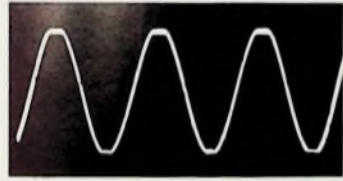
Bild 21. Sinus-Ausgangsspannung des Verstärkers beim Abkappen
