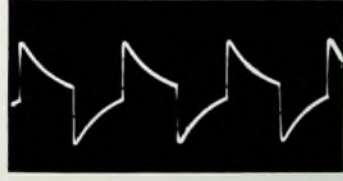
Bild 25. 1000-Hz-Rechteckdurchlaß des Verstärkers bei eingeschaltetem Rumpelfilter
