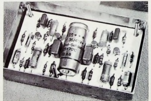
Bild 16. Ansicht des Entzerrer-Vorverstärkers mit Abschirmgehäuse
