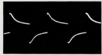
Bild 22. Oszillogramm der Rechteck-Ausgangsspannung bei 40 Hz
