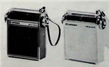
Bild 2. Taschenempfänger „TH-831“ von Hitachi mit Linearskala.
