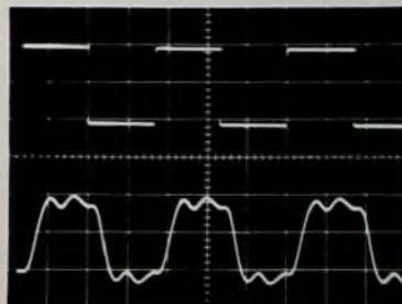
Bild 5. Impulsverhalten bei Rechtecksignalen 2 V eff (horizontal: 50 \mu\text{s} /Teil)
