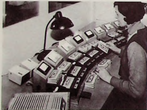
Bild 5. Bandlaufprüfung in der Endkontrolle
