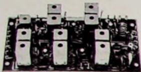
SUU 2 Konverter 144...146/9 MHz mit Injektionsfrequenzaufbereiter 135...137 MHz... DM 168,-
