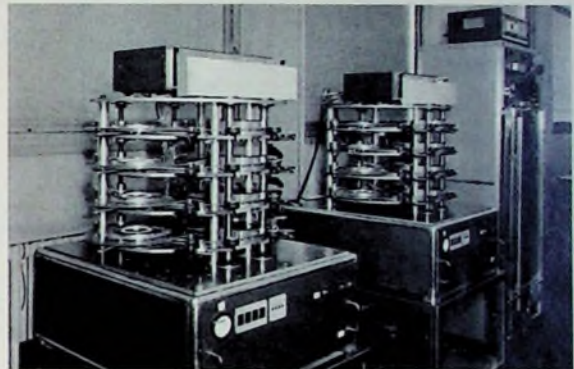
Bild 3. Schnellkopieranlage; hinten rechts die Mutterbandabspielmaschine mit vertikaler Bandführung, vorn zwei 4-Deck-Tochtermaschinen
