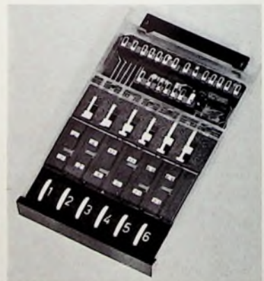
Bild 5. Neue Potentiometer-Speichereinheit von Valvo in Schubladenform
