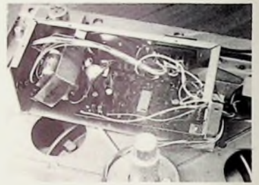
Bild 2. Steuerelektronik unter dem Laufwerkchassis montiert
