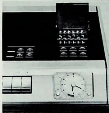
Bild 2 Der eingebaute Fernsehempfangsteil des Recorders ist mit einem Programmspeicher für sechs verschiedene Fernsehsender ausgestattet, die über Tasten gewählt werden können. Eine Schaltuhr erlaubt das Aufnehmen von Programmen zu vorbestimmten Zeiten in Abwesenheit des Benutzers.
