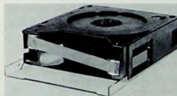
Bild 3 Die VCR-Cassette (von hinten gesehen) enthält zwei übereinanderliegende Bandspulen für eine maximale Spielzeit von 60 min; die diagonale Bandführung an der Kopftrummelseite der Cassette ist deutlich zu erkennen.
