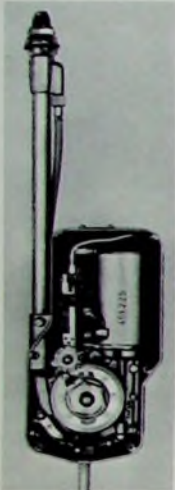
Antrieb der vollautomatischen Autoantenne „Auta 6000 H“ (Hirschmann)
