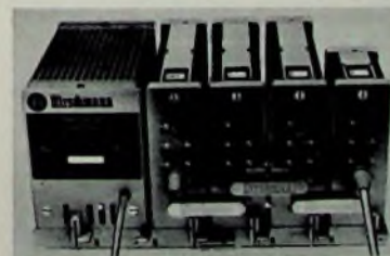
Kombination des „TOP“-Systems mit einem Netzgerät und vier Verstärkern (Hirschmann)
