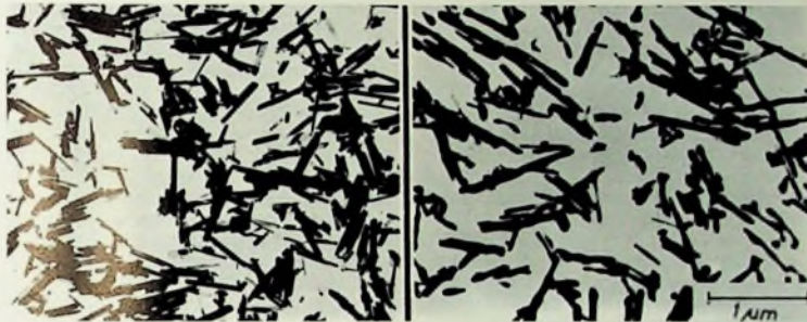
Bild 1. Größe und Schichtung der aktiven Partikel beim Chromdioxidband (links) und Eisenoxidband (rechts)
