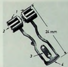
Bild 2. Stimmgabel der Unisonic-Armbanduhr (1 Magnetspulen, 2 Dauermagnet, 3 Halterung, 4 Basisunterteil)
