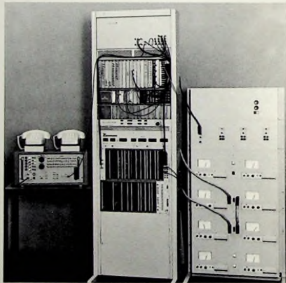
Bild 3. Deutsche TDMA-Versuchssystem. In der Mitte eine Endstelle mit (von oben nach unten) Modem, senderseitiger Ablaufsteuerung, Überwachungsfeld, empfangsseitiger Signalverarbeitung und Raum für 120 Kanaleinheiten einschließlich Coder und Decoder; links ein Simulator für die Referenzstation, rechts der Stromversorgungssteil
