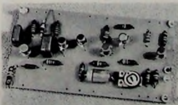
Bild 4. Blick auf die bestückte Platine des Drehzahl-Kontrollgerätes
