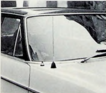
Bild 8. Die montierte 40 cm lange aktive Autoantenne
