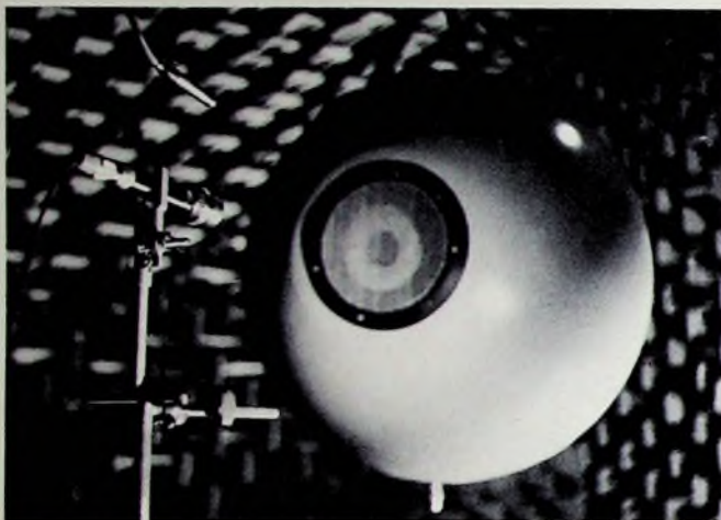
Meßanordnung im schalltoten Raum des Philips-Werks Breda. Über dem zu messenden Mikrofon befindet sich ein Meßmikrofon zur Steuerung des Regelverstärkers für den in einem kugelförmigen Gehäuse untergebrachten Lautsprecher zur Erzeugung eines konstanten und möglichst gleichmäßigen Schallfeldes
