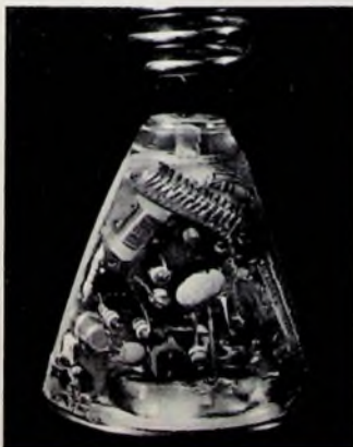
Bild 9 Kunststoff-Fuß mit den Bauelementen der aktiven Antenne
