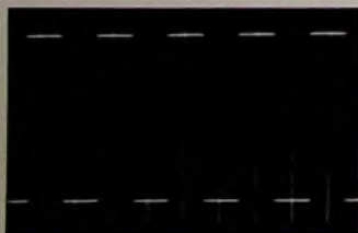
Bild 4. 1-kHz-Rechtecksignal mit Tastverhältnis 1:1 (Horizontalablenkung 0,5 ms/Rasterteilstrich, Vertikalablenkung 2 V/Rasterteilstrich)
