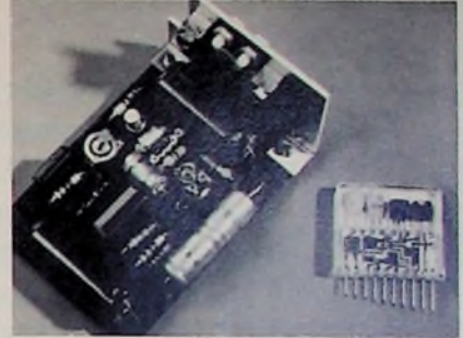
Bild 2 Größenvergleich zwischen einem in üblicher Weise gefertigten NF-Vorverstärkerbaustein (links) und dem entsprechenden Dickschicht-Modul
