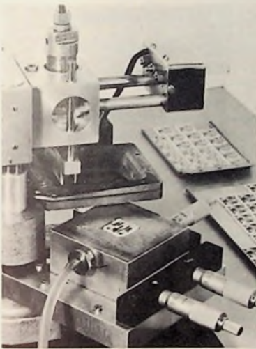
Bild 1 Siebdruckmaschine zum Bedrucken von Keramik-Substraten
