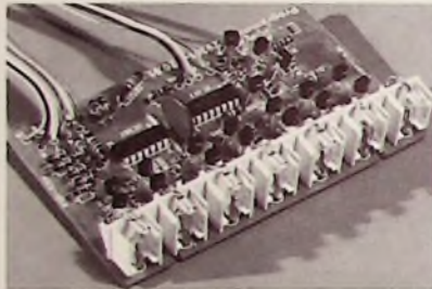
Bild 12 Programmwahl-Baustein, im Vordergrund die Steckanschlüsse und Glühlampen für die Impulsfelder, die durch Berühren die Programm-Umschaltung bewirken
