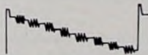
Bild 12 Schwingungen in der Grautreppe, wenn Koppelkondensatoren im Y-Signalzweig (zur Matrix hin) unterbrochen sind.
