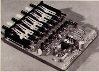
Bild 11 Elektronik-Baustein; rechts von der Einstelleneinheit für die Bereich- und Kanal-Vorwahl die Transistor-Schaltstufen; daran anschließend der integrierte Binärzähler mit BCD-Dezimaldecoder und Treiber für die Ziffernanzeigeröhre, mit deren Katodenspannung zugleich die Schalltransistoren angesteuert werden
