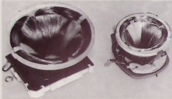
Bild 9 Größenvergleich der Ablenkspulen für Lochmasken-Röhre (links) und Trinitron-Röhre (rechts) gleicher Schirmbildgröße
