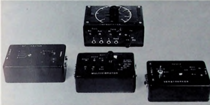
Bild 1. Ansicht der Experimentierbausteine: Integrator und Sinusformer (oben Mitte), Komparator (unten links), Multivibrator (unten Mitte), Verstärker (unten rechts)
