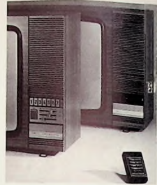
Bild 13 Bedienteil eines Farbfernsehempfängers mit sieben Impulsfeldern (links) und mit Ultraschall-Fernsteuerung (rechts); im Vordergrund rechts der Sender der drahtlosen Fernsteuerung „tele-dirigent“
