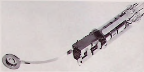
Bild 4. Elektronenkanone für eine 46-cm-Trinitron-Röhre nach Bild 2
