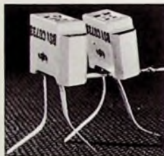
Bild 3 Thyristoren für geregelte Blitzgeräte ( Siemens )
