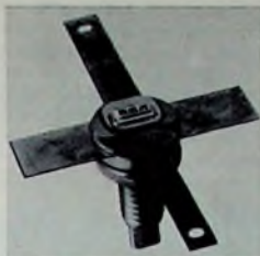
Bild 7. Bei 400 MHz liefert dieser Transistor 2N6104 rund 30 W bei 5 dB Leistungsgewinn (RCA)
