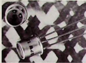
Bild 9. Phototransistor mit weitem Öffnungswinkel ( AEG-Telefunken )
