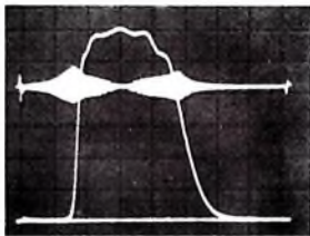
Bild 7. Durchlaßkurve eines schmalbandigen 10,7-MHz-Filters bei zu großer Wobelfrequenz (25-Hz-Sägezahn)
