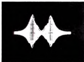
Bild 5. Messung des Frequenzhubs mit 1-MHz-Quarzspektrums (Trägerfrequenz 33,5 MHz, Hub etwa \pm 12 \text{ kHz} )
