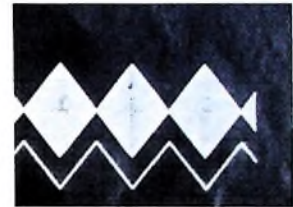
Bild 4. Mit einem externen 5-kHz-Sägezahn modulierter 389-MHz-Träger (oben) und 5-kHz-Sägezahnmodulation (unten)
