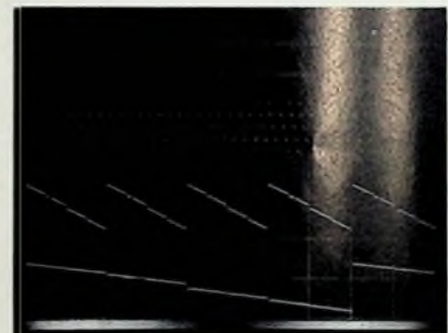
Bild 14 (oben) Teilerschaltung mit Rechteck- und Sägezahn- ausgängen sowie großer an- nähernd gleicher Amplitude für alle Ausgänge
