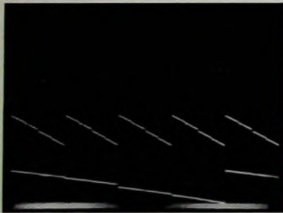
Bild 14 (oben) Teilerschaltung mit Rechteck- und Sägezahn- ausgängen sowie großer an- nähernd gleicher Amplitude für alle Ausgänge
