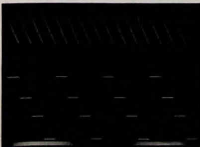
8 kHz (a) Bild 12. Sägezahn-Muttersignal U_a mit 8 kHz (a) und Ausgangssignal U_{a,2} mit 2 kHz (ohne R_3 , b); Vertikalachse 5 V/Rastertlg. (a) beziehungsweise 0,5 V/Rastertlg. (b). Horizontalachse 2 ms/Rastertlg.
