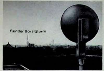
Bild 1. 12-GHz-Empfangsanlage in Berlin-Tegel
