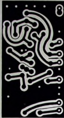
Bild 4. Leiterplatte des HF-Teils (Maßstab 1:1)
