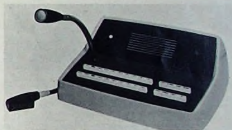
Bild 2. Besprechungsstelle der Feststation mit Selektivvorrichtung ▶
