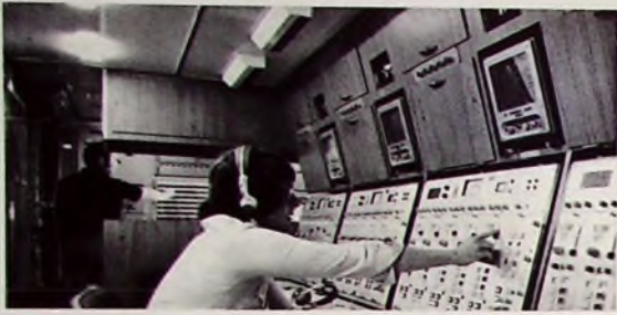
Bild 3. Blick in das Innere des Übertragungswagens mit den Überwachungseinheiten für 25 Kommentatoren (Foto: ZDF)
