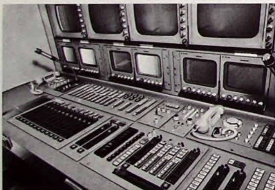
Bild 1. Bildregieraum im Fernseh-Übertragungswagen (Foto: Robert Bosch Fernsehanlagen GmbH)
