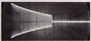
Bild 13 Klavierähnlich, ohne Pedal Schleifer von P 1 an U_B , von P 2 etwa Mitte und P 3 an Diode; S 1, S 2 an a und S 3 an b Vertikalablenkung 0,1\text{ V/Rastertlg.} Horizontalablenkung 200\text{ ms/Rastertlg.}
