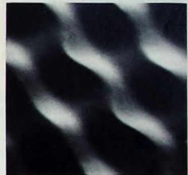
Bild 1. Elektronenrastermikroskop-Aufnahme der Muttermatrize des Bildplatten-Systems TED in 22 000facher Vergrößerung
