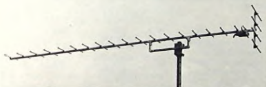
Bild 12. 23-Element-Antenne für das 70-cm-Amateurband (Wisi)
