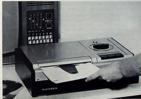
Bild 7. Einführen der Bildplatte mit Plattentasche in den Einzelplattenspieler
