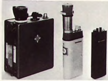
Bild 1. Größenvergleich der tragbaren „Teleport“-Funksprechgeräte „V“, „VI“ und „VII“ (Aufbau mit Röhren, Halbleiterbauelementen beziehungsweise Siebdruckmodul)
