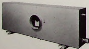
Der Belastungswiderstand RBN 60/60 (bis 60 kW) ist als Kettenleiter aufgebaut. An seinem Meßausgang kann eine um 60 dB geschwächte Leistung abgenommen werden. Ein Luftstromkontakt schaltet bei Ausfall der Gebläsekühlung den Sender ab.
