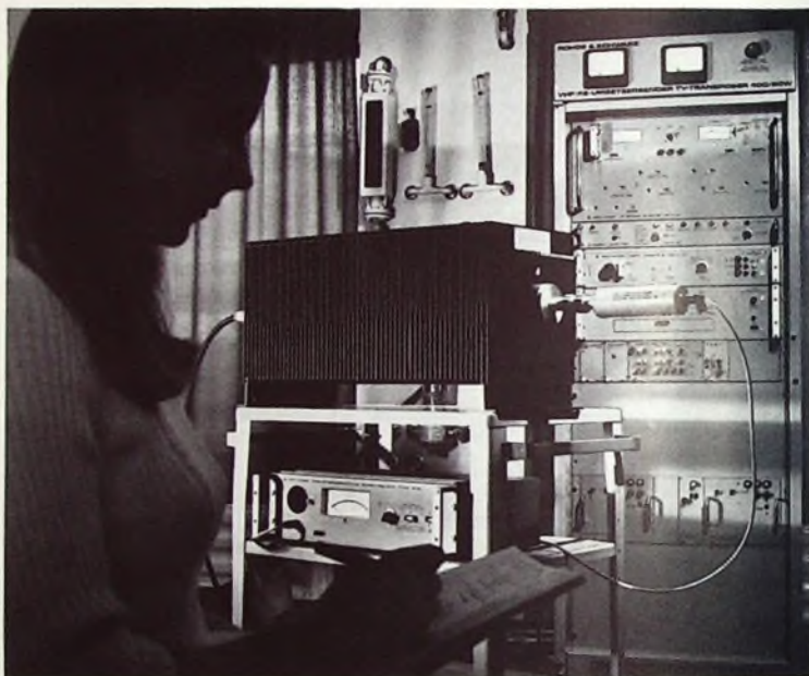
Die Ausgangsleistung eines VHF-TV-Umsatzersenders wird hier mit dem Thermischen HF-Leistungsmesser NRS (Mitte unten) gemessen. Gemäß IEC-Publikation 244-1 ist anstelle der Antenne ein Belastungswiderstand (Typ RBU) angeschlossen. Dieser enthält außerdem ein Dämpfungsglied, das die Ausgangsleistung auf den für das Meßgerät zulässigen Wert herabsetzt.
