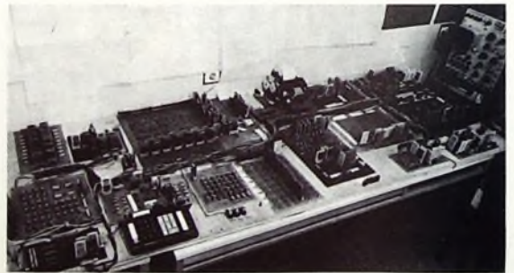
Bild 2. Konventionelle Brettschaltung für einen Tischrechner „CP 1-F 1“
