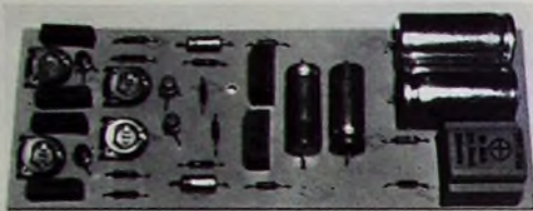
Bild 6 Fertig bestückte Leiterplatte des Aussteuerungsmessers für Netzbetrieb
