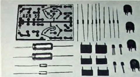
Bild 12. Platine und Bauelemente des Aussteuerungsmessers für Batteriebetrieb
