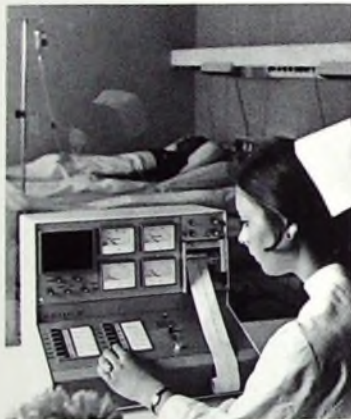
Bild 4 Zentrales Kontrollgerät „Sirecust C 1“ für die Patientenüberwachung (Siemens)
