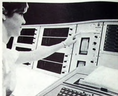
Bild 5 Zentraler Überwachungsplatz mit Rechner-Verarbeitung der Messwerte und alphanumerischer Bildschirmdarstellung für acht Patienten (Westinghouse)
