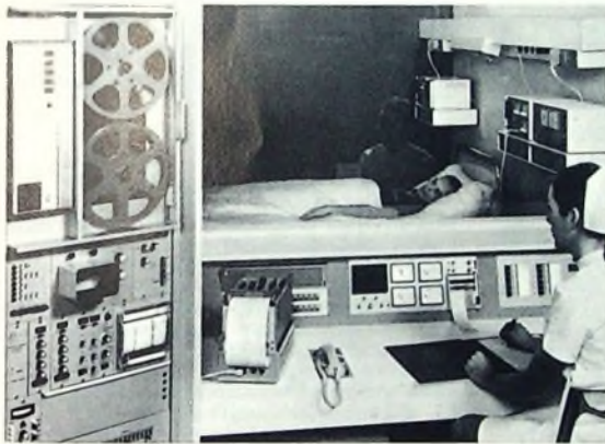
Bild 6. Analog-Magnetbandspeicher „Medi-tape AR“ für Vitalwerte mit Formanalysator für EKG und Elektrokardiograf zur Arrhythmieausschreibung (Siemens)
