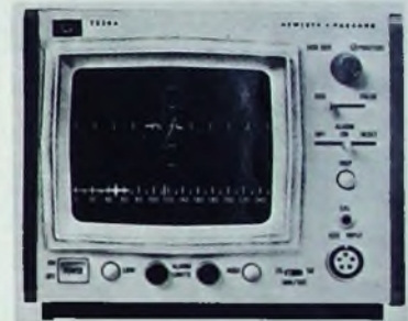
Bild 2. Das Schirmbild-Überwachungsgerät „7830 A“ von Hewlett-Packard zeigt wahlweise das EKG oder die Pulskurve sowie die Herzfrequenz mit einstellbaren Alarmgrenzen
