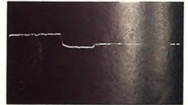
Bild 4. An Stelle einer Durchgangsdose versehentlich eingebaute Enddose
