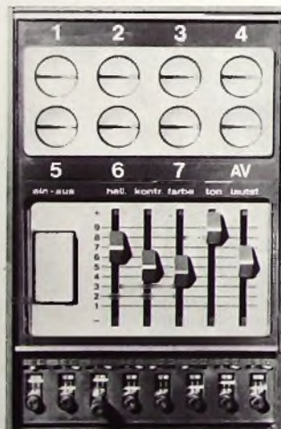
Bedienteil des „PALcolor 753 servo-automatic“ mit offener Programmierereinheit
