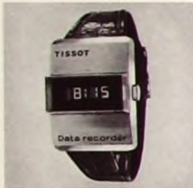
Bild 3 Armbanduhr mit Flüssigkristall-Digitalanzeige (Tissot)
