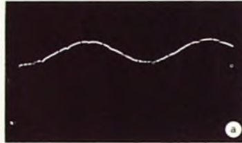
Bild 10. Netzverbrummte Antennenleitung, a) ohne BrummfILTER gemessen, b) mit BrummfILTER gemessen
