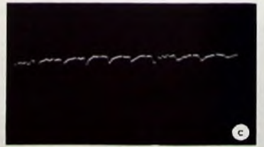
Bild 5. Antennenleitung mit richtig eingebauten Steckdosen: a) Y-Verstärkung \times 1 , b) Y-Verstärkung \times 2 , c) Y-Verstärkung \times 5 (die geringe Fehlanpassung der einzelnen Steckdosen ist deutlich erkennbar)
