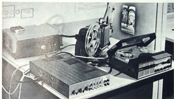
Bild 1. Vertonungssystem für die Projektion von Film und Dias (Aufnahme Schwahn)
