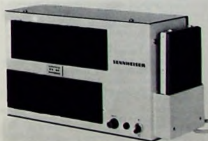
Bild 3. Ladegerät „D 556-2“ zum Aufladen der Akkumulatoren von 10 Empfängern und des Akkumulators des Senders
