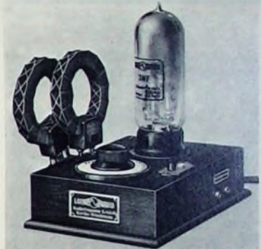
Aufbau der Loewe-Dreifachröhre ◀
