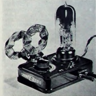
Loewe-Ortsempfänger „OE 333“ aus dem Jahr 1926, der erste Rundfunkempfänger der Welt, der in über einer Million Stück produziert wurde ▶
