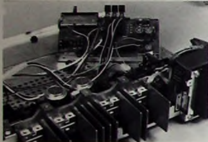
Blick auf den Quadro-Endverstärker des „HiFi-Studio 2040 Quadro“ und eine Platine mit dem Quadro Balanceregler, dem Lautsprecher-Wahlschalter und dem SQ-Matrix-Decoder
