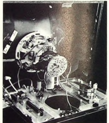
Bild 1. Grundplatte und Steckmodule eines Farbfernsehempfängers der Studie „Color 77“
