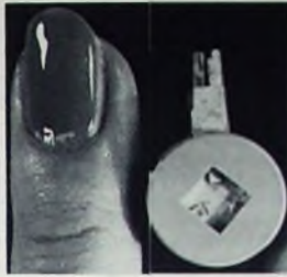
Kaltleiterkombination Q 63100 zur Entmagnetisierung von Farb-bildröhren (Siemens)
