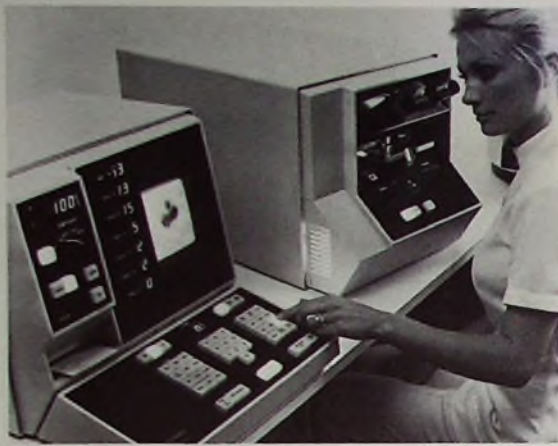
Bild 3. Meßplatz (Mikroskop mit Scanning-Einrichtung, Display mit prozentualer Ziffernanzeige, Hilfsgerät zur Herstellung des Blutausstrichs und Rechner) zur Unterscheidung von sechs verschiedenen Arten von weißen Blutkörperchen (Leukozyten); rechts: Mikroskop mit vom Rechner gesteuerter Objektträgerbewegung; links: Bedienungsteil mit Schirmbild Darstellung des mikroskopischen Gesichtsfeldes, prozentualer Anzeige der verschiedenen Zelltypen und Einrichtung zum Ausdrucken der Meßergebnisse. Der Rechner „PDP 8“ befindet sich nicht sichtbar unterhalb der Tischplatte („LARC-Analyzer“ des Biomedical Technical Center of Corning Glass Works, Raleigh, N.C.)
