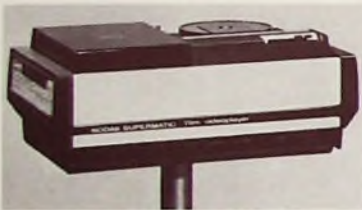
Kodak-Videoplayer „VP-1“ für die Abtastung von Super-8-Filmen in „Supermatic“-Kassetten
