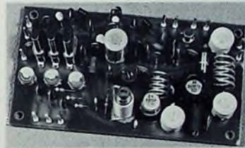
Bild 3. 2-m-FM-Sender-Baustein mit drei Quarzen (Conrad)
