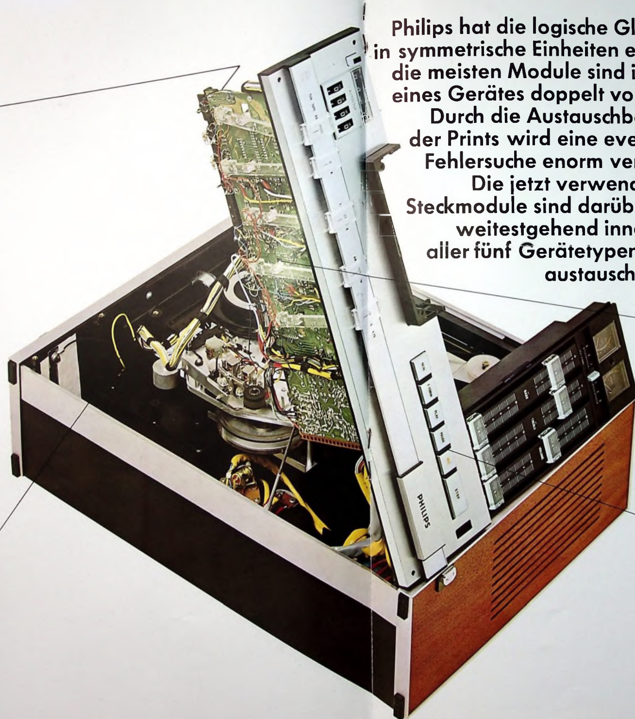
N 4418 Deutlich erkennbar die paarweise Anordnung gleicher Module.
