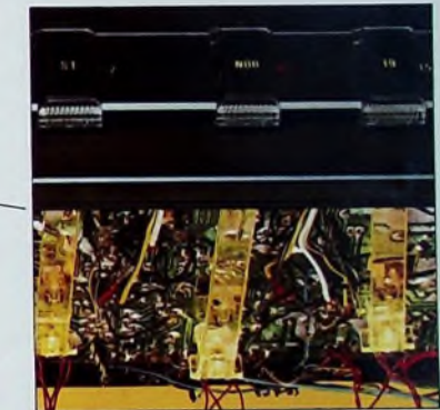
N 4510 Modern gestaltete Funktionsschieber aus Kunststoff mit Lichtführung auf die eingestellte Funktionsanzeige.
