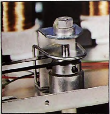
N 4414 Die axial zweiseitig gelagerte Bandteller- Achse läßt sich verblüffend einfach justieren (Rückseite).
