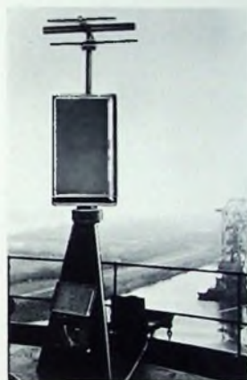
Bild 1. Fernsehantennen für die Bereiche III und IV/V am Schiffsschornstein
