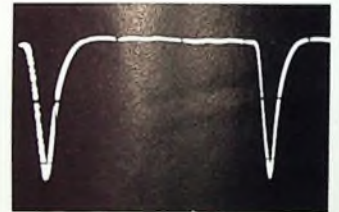
Bild 3. Zeilensynchronimpuls am Testpunkt TP1
