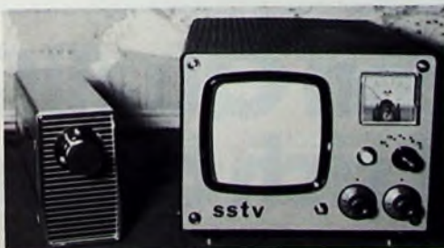
Bild 1 SSTV-Anlage mit Kamera
