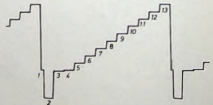
Bild 6. Die mit einem Kompensationsschreiber durchgeführte Registrierung läßt sich mit Eichspannungen (Spannungstreppe: 1: 8 mV, 2: -304 mV, 3: -2 mV, 4: 6 mV, 5: 83 mV, 6: 162 mV, 7: 241 mV, 8: 318 mV, 9: 392 mV, 10: 476 mV, 11: 554 mV, 12: 691 mV, 13: 911 mV) mit Fehlergrenzen < \pm 1\% ausmessen
