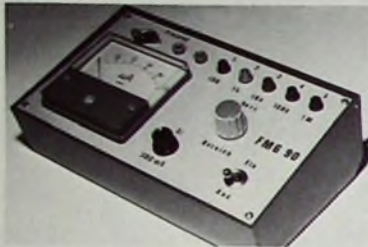
Bild 1 Ansicht des Frequenzmessers im pultförmigen Teko-Gehäuse
