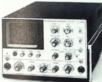
Bild 1. Abtast-Oszillograf „PM 3400“ in Kompaktbauweise mit sequentieller Abtastung und interner Triggerung (Bandbreite 2 GHz)
