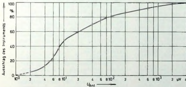
Bild 2 Ausschlag des Abstimmanzeigeelements in Abhängigkeit von der Antennenspannung U_{Ant} am 240-Ohm-Antenneneingang ( f = 102 MHz); ab U_{Ant} = 3 mV ist die Regelung des HF-Teils voll wirksam, so daß die Verstärkung nicht weiter ansteigt
