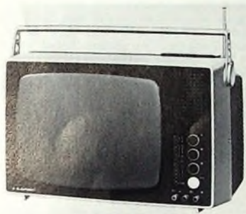
Bild 1. Schwarz-Weiß-Portable „Scout Royal“ mit elektronischem Sendersuchlauf
