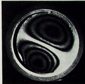
Bild 12. Augenblickshologramm einer auf einer bestimmten Resonanzfrequenz schwingenden Telefonmembran aus piezokeramischer Schicht mit rückseitig aufgedampften Metallschichten als Elektroden
