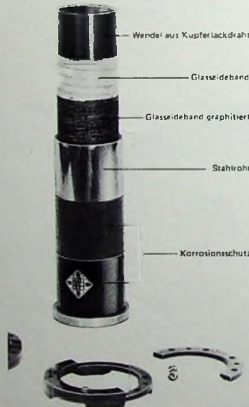
Bild 1. Weitverkehrs-Wendelhohlleiter mit Kupplung (AEG-Telefunken)
