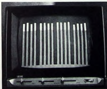
Bild 1. Aussteuerungsanzeige für 16 Kanäle auf einem 23-cm-Fernsehmonitor
