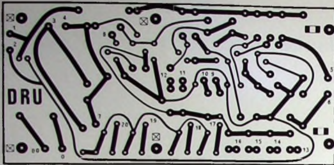
Bild 4 Printplatte für den photoelektronischen Drehzahlmesser (Maßstab 1:2)
