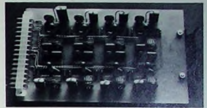
Bild 2. Platine „17.16.1.1“ (Balkengenerator für jeweils 8 Kanäle)
