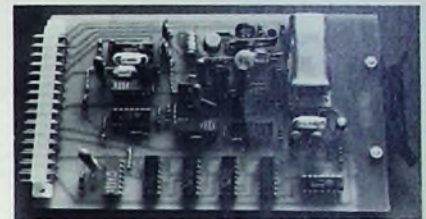
Bild 3. Platine „17.16.1.2“ (Impulsgenerator, Synchronimpulserzeugung, Austastung, Übersteuerungsaufhellung, Klemmstufe und Video-Endstufe)
