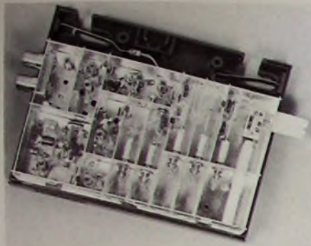
Bild 4 Geöffneter „Sicaset“-Frequenzumsetzer „SAFK 3541“ in Kassettenform (Siemens)
