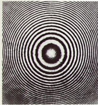
Bild 15 (unten). Holographisch erzeugte Zonenlinse
