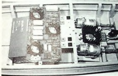
Bild 1 (oben) Eisenloser Gleichspannungswandler in einem Modellboot für den Betrieb von zwei 12-V-Motoren an einem 6-V-Akku
