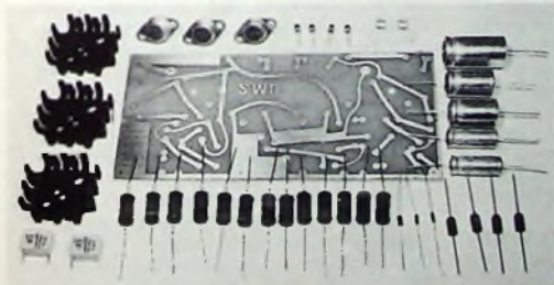
Bild 4. Printplatte für den eisenlosen Gleichspannungswandler (Maßstab 1:2)
