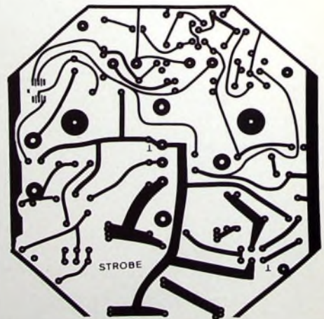
Bild 5. Printplatte für das Lichtblitz-Stroboskop (Maßstab 1:2)
