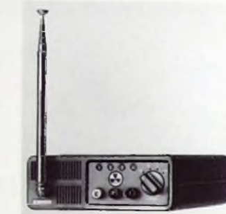
Bild 4. Eurosignal-Empfänger „E 11-2“ von TeKaDe
