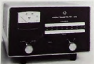
Bild 2. Linear-Transverter „F 270“ zur wahlweisen Bestückung mit Convertoren und Mischern (Fischer)
